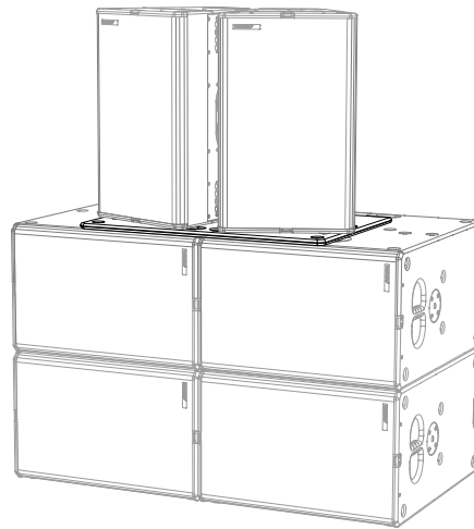
Abbildung 4.9.1 - Systemaufbau mit B30 Lautsprechern quer
