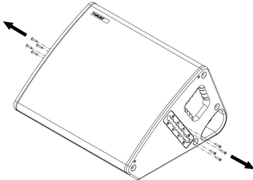
Abbildung 4.4.1 - Entfernen der Senkschrauben am C15 Lautsprecher
