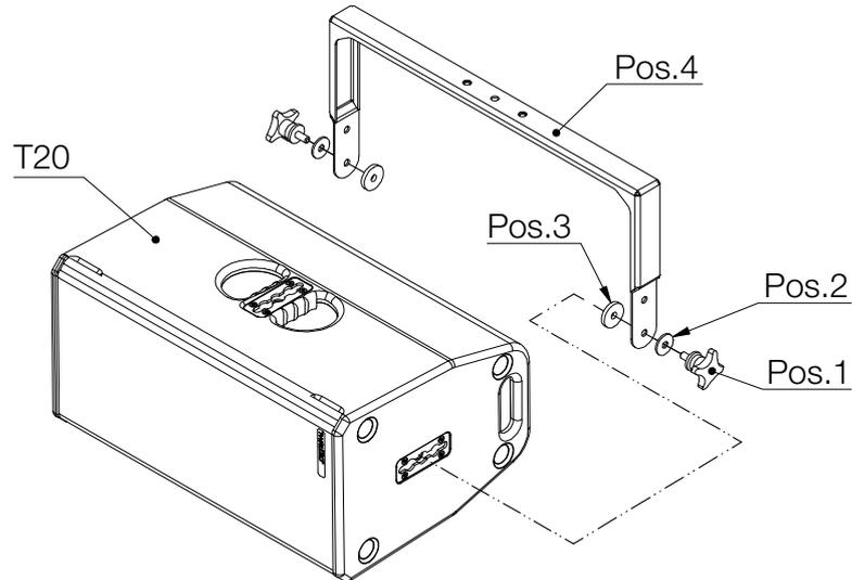
**Abbildung 4.5 - Montage QBT20 an T20 Lautsprecher**
