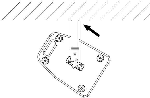
Abbildung 4.6 - QBT20 mit T20 an Decke montiert
