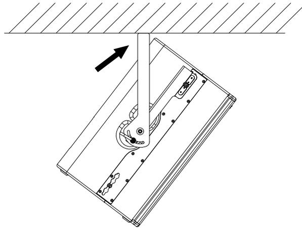
Abbildung 4.4 - SBT24 mit T24N an Decke montiert
