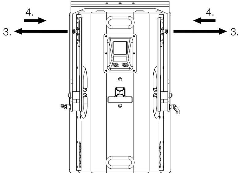
Abbildung 4.3.2 - Rasthebel einrasten
