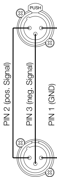
Abbildung 4.9.1 - Passive Weiterleitung des Eingangssignals (Anschlüsse 1 und 3)
