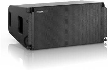
Der VERA20 Lautsprecher ist mit zwei 10" Chassis für den LF-Bereich und einem Waveguide mit einem 1,4" Hochton-Kompressionstreiber bestückt. Im Vergleich zu typischen Doppelachtzoll Arrays kann das VERA20 mit seinen zwei 10" Treibern bis zu 6 dB mehr Output bei weniger Verzerrungen im Low-Mid Bereich erzeugen.
