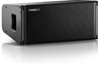
Der VERA20i Lautsprecher ist mit zwei 10" Chassis für den LMF-Bereich und einem neu entwickelten Waveguide mit einem 1,4" Mittelhochton-Kompressionstreiber bestückt. Im Vergleich zu typischen Doppelachtzoll Arrays kann das VERA20i mit seinen zwei 10" Treibern bis zu 6 dB mehr Output bei weniger Verzerrungen im Low-Mid Bereich erzeugen. Aus dem nur 60 cm breiten und 28 cm hohen Lautsprecher lassen sich vertikale Arrays mit bis zu 24 Elementen aufbauen.
